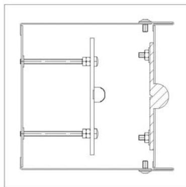
Vollrelief-Buchstabe mit umlaufender Blendschutzkante. Das Neonrohr oder ein stilisiertes Neonrohr aus Acrylglas mit LED-Ausleuchtung - in Balkenbreiten von 16, 20, 26 oder 30 mm - ist auf dem Oberteil montiert. Exakt abgegrenzte Lichtbündelung auf dem Oberteil durch Blendschutzkanten.
