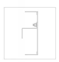
Halbrelief- bzw. Vollrelief-Buchstabe unbeleuchtet, aus Aluminium, Edelstahl oder Kupfer. Fertigung auch mit Boden möglich (siehe Zeichnung Mitte). Einfache Montage des Halbrelief-Buchstabens mit Schlüsselloch-Z-Winkeln an Fassaden, Blenden, usw. (siehe Zeichnung rechts).
